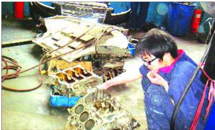
拆卸开的发动机,其中一个气缸的拉缸痕迹清晰可见。
