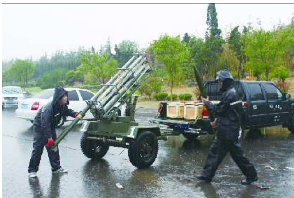
▲火箭弹作业人员正在将火箭弹装进火箭架的导轨。
