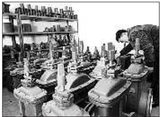
自来水公司的张凡荣在仓库检查供水阀门,准备检修时更换。
