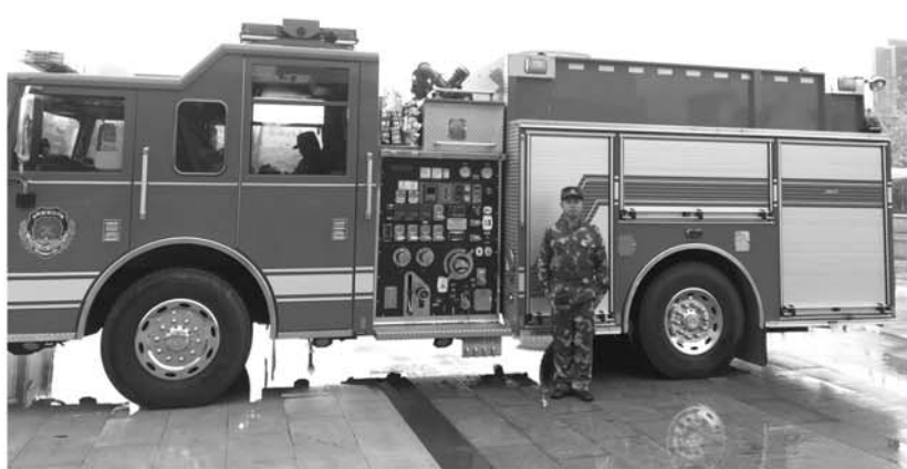
超高层供水消防车——主要用于扑救大型商场等高层建筑火灾,供水高度可达320米,车内还配有消防斧等常规破拆类器材。
