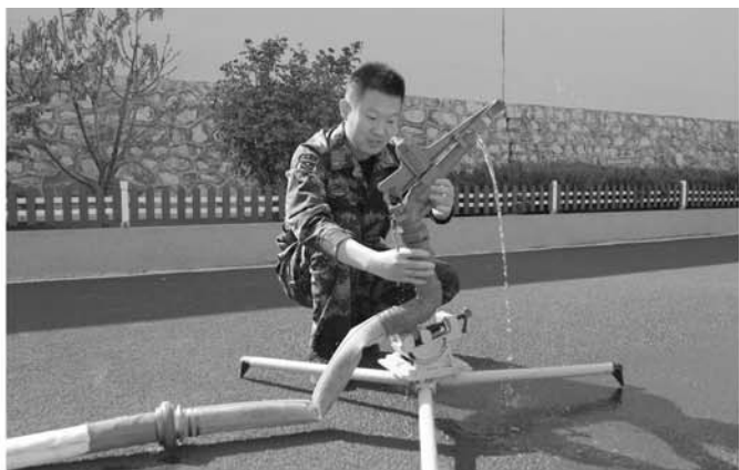
折叠式自摆水枪——可以在无人操作前提下自动摇摆喷水,实现人工上下90度调节、自动左右摇摆180度射水。
