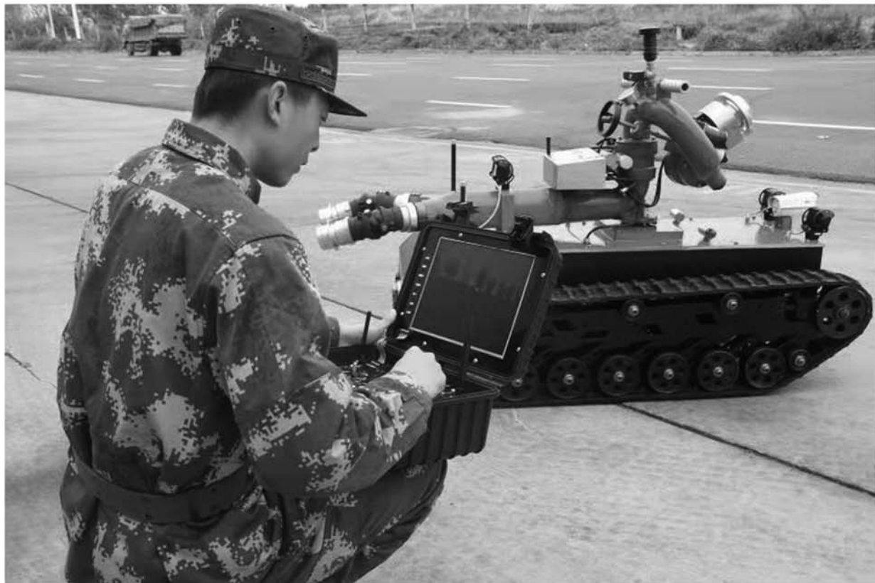
消防机器人——可以代替消防队员进入火场实施有效的灭火救援、稀释降温、火场侦察,爬坡能力较强,可声光报警。
