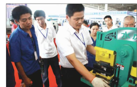
在一台多功能机器前,工作人员正在展示它的“威力”,引得市民驻足观望。据介绍,这台机器是多种普通机器的综合体,操作过程只需换模具,极为方便。
