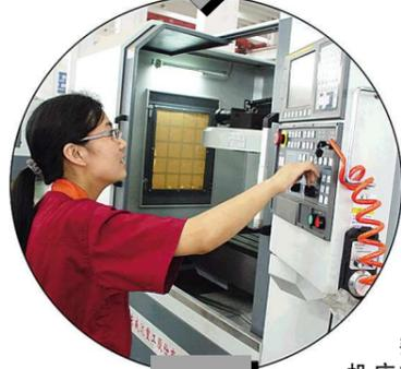
数控机床能精确到毫米级的加工精度。
