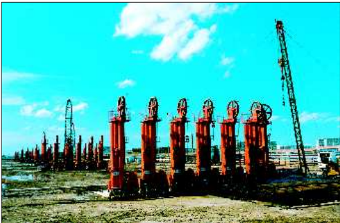
胜利油田最大的丛式井组—河50井组由42口定向斜井组成，创出7项全国定向钻井新纪录，获国家科技成果一等奖
