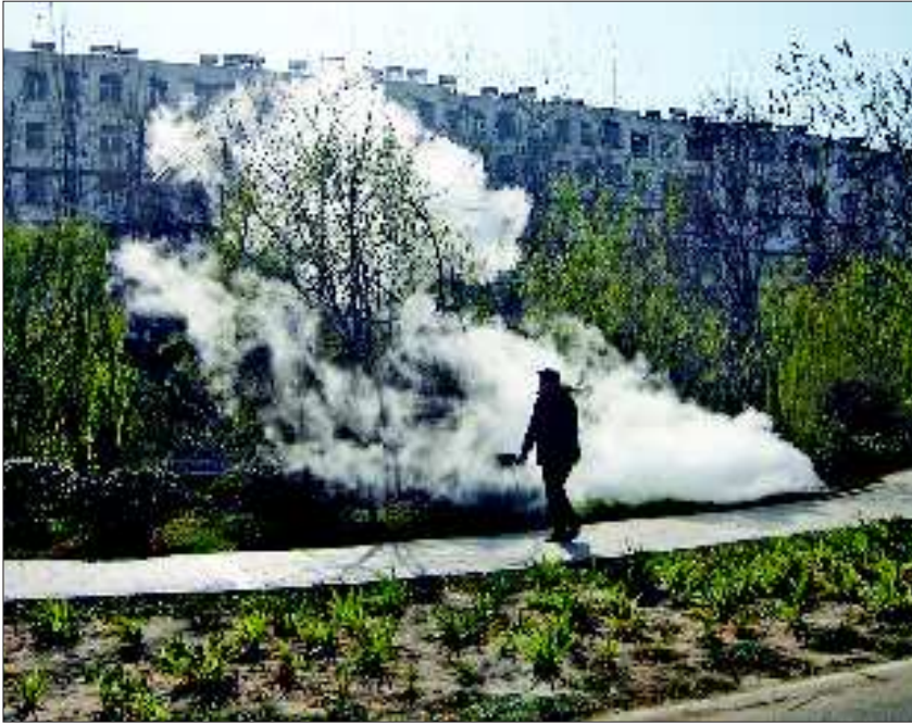
热气冲天 6日,记者从城区洸河路上的洸河绿地处看到,从下水道井盖中冲出两股冲天的热气,比此前多了一处。据了解,暖气管道并无损坏,只是井口附近有积存的雨水,形成了煮管现象。相关部门表示,将尽快组织人员去处理现场,把渗入井盖内的水给抽出来。 刘守善 吴鹏 摄
