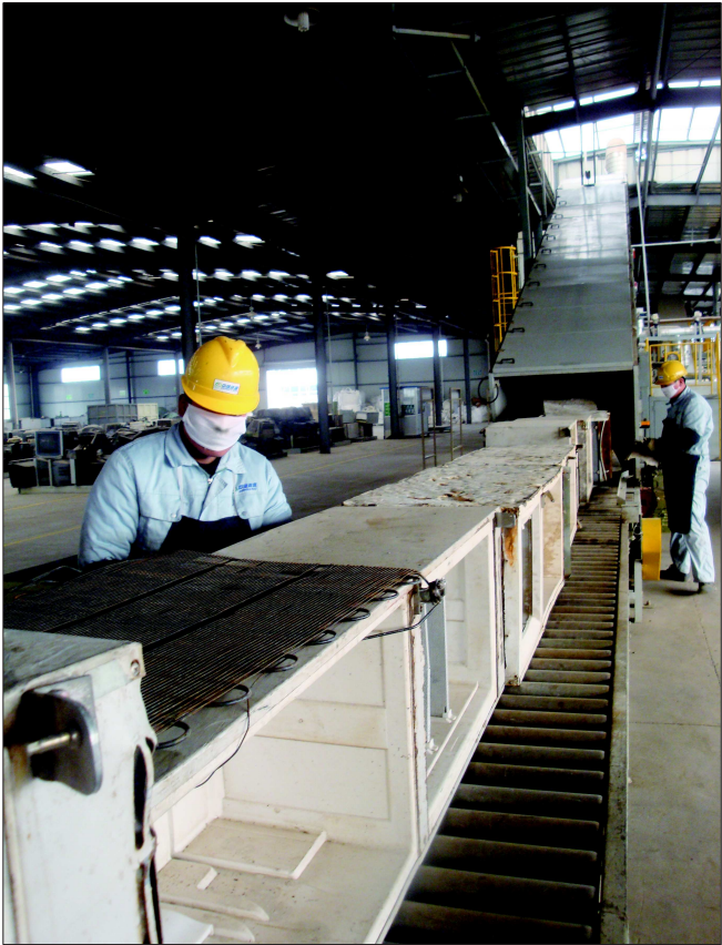
▲冰箱拆解线,工人正在进行预处理。
