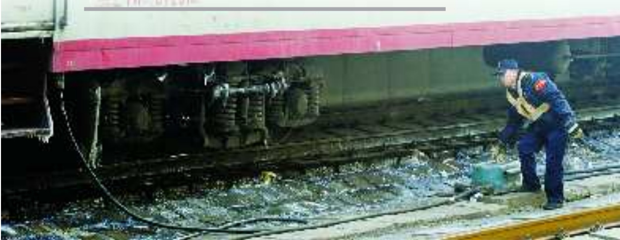
列车停靠济南站,工作人员利用上下客时间为火车上水。
