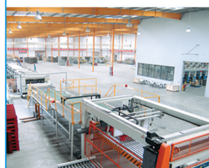
全自动三层瓦楞纸板预印彩箱生产线
