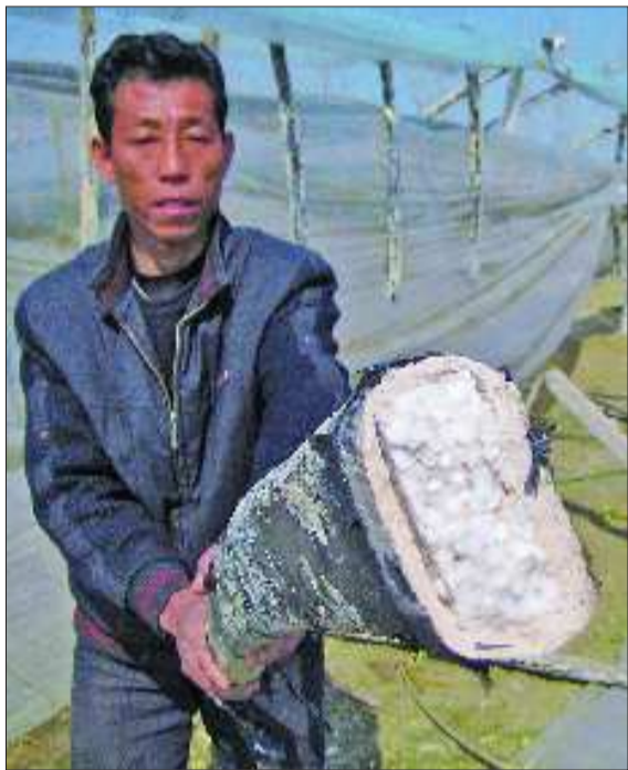
3月10日上午,在日照涛雒镇下元二村,村民冯建伟拿着断裂了的大棚支架,支架中间全部是塑料泡沫。
