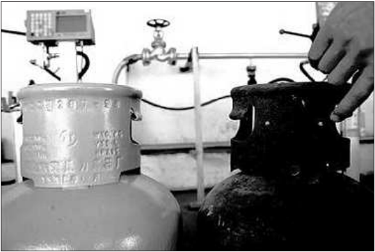
▲左边为焊接液化气瓶,右边没有编号的为被要求强制退役的“螺丝瓶”。
