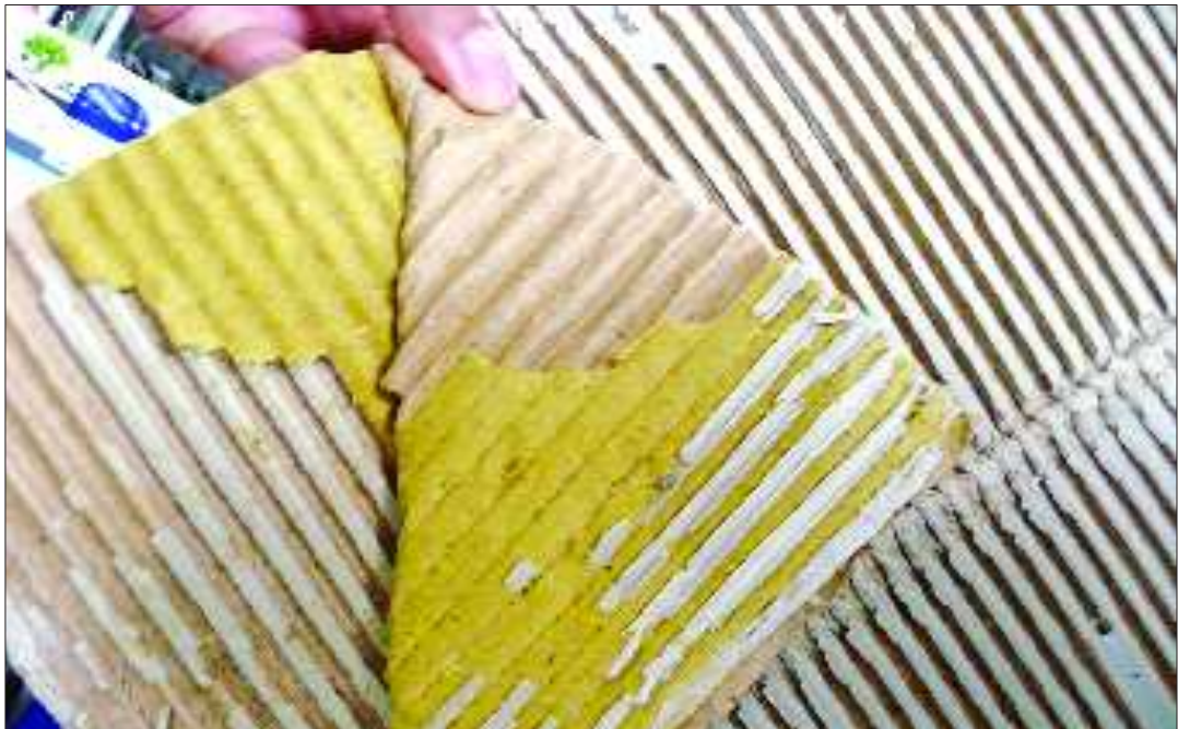
剥开水泥纸箱可以看到，原本应空心的蜂窝纸壁里，灌满了灰白色的水泥浆。
