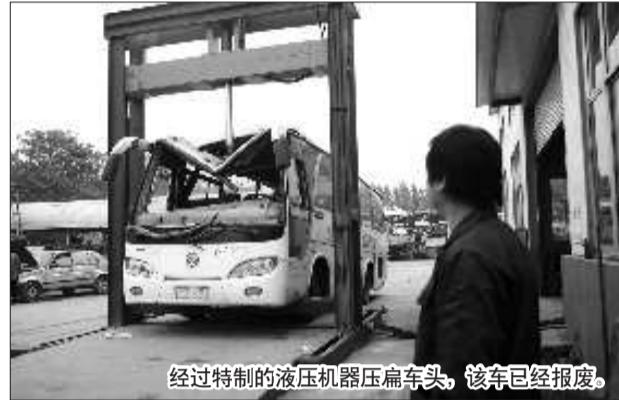
经过特制的液压机器压扁车头，该车已经报废。
