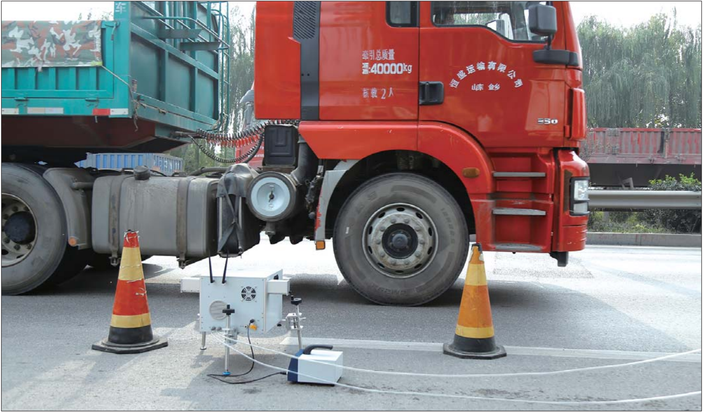
正在进行机动车排气污染遥感监测。
