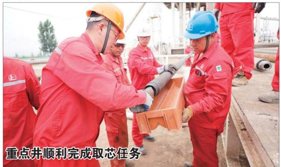
近日,由胜利石油工程有限公司黄河钻井70183队承钻的樊页平1井钻至井深3458米,顺利完成第一筒岩心取芯任务,岩心收获率95.3%,比设计提高10.3%,见到良好油气显示。据了解,樊页平1井是胜利油田勘探管理中心在济阳坳陷东营凹陷博兴洼陷樊119井鼻状构造带部署的一口预探井,对油田页岩油开发具有重要意义。施工中,针对地层复杂、施工难度大、井下风险高等诸多难点,黄河钻井总公司以"百日攻坚创效"行动为契机,通过优化全井方案、细化施工措施,实现了项目阶段施工安全优质高效。
