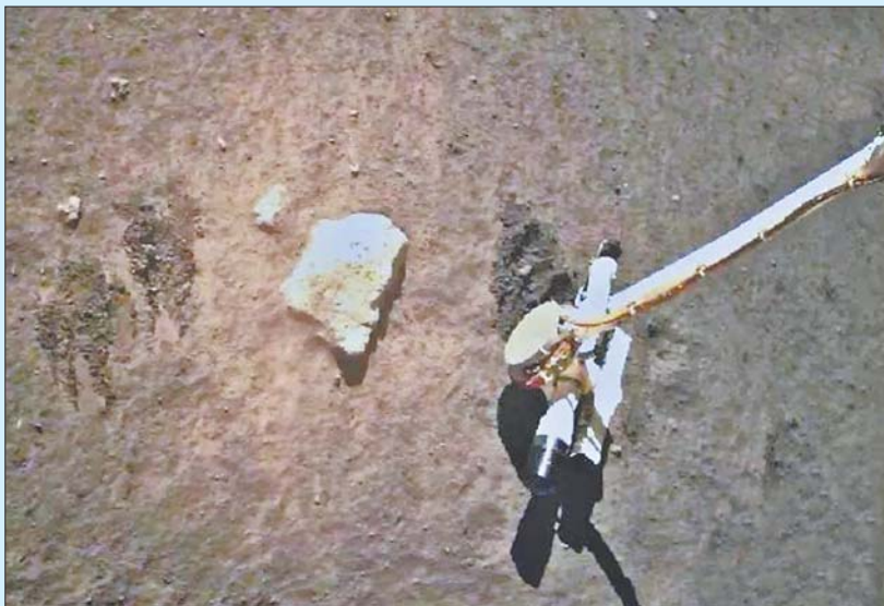
嫦娥五号探测器在月球表面自动采样。 国家航天局供图
