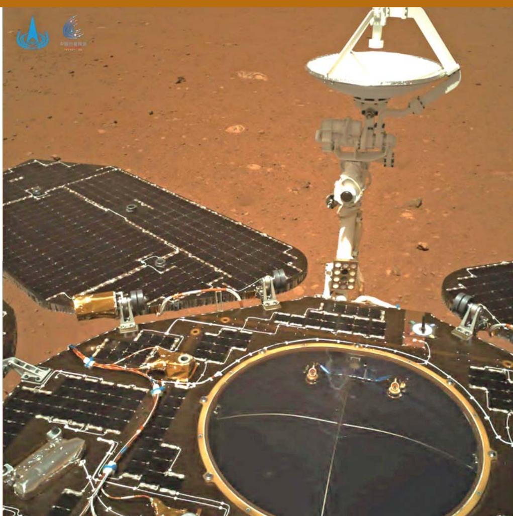
5月19日,国家航天局发布我国首次火星探测任务天问一号探测器着陆过程两器分离和着陆后火星车拍摄的影像。图像中,着陆平台和“祝融号”火星车的驶离坡道、太阳翼、天线等机构展开正常到位,火星表面纹理清晰,地貌信息丰富。
