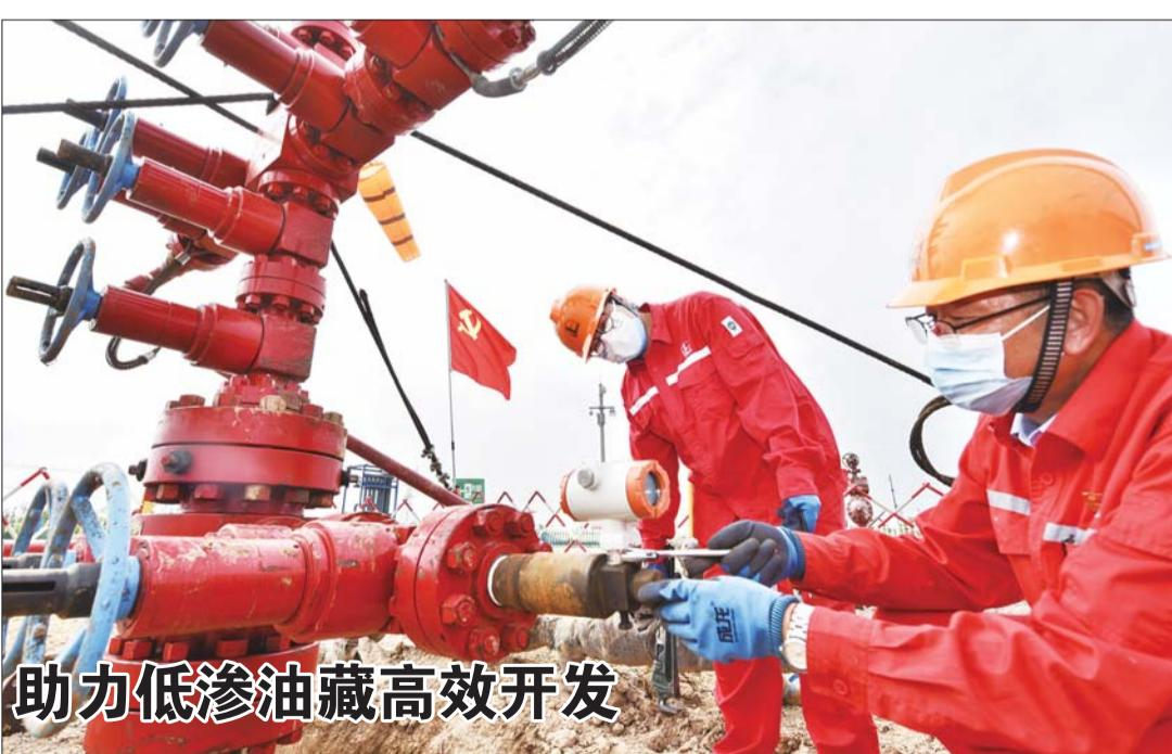
近日,胜利油田河口采油管理四区注采404站党员突击队,克服高温天气等不利影响,在渤海油田5号台义178—X15井组,检查压驱注水新技术施工前的准备工作。据了解,特低渗油藏密度大,常规注水补能模式难以解决开发难题。为此,河口采油厂自2020年以来,先后在渤海、大北等油田实施压驱注水新技术获得成功,目前已实施压驱注水100井次,累计增油3.9万吨。其中,义7-2井组是胜利油田第一口压驱注水开发单井,日产油从5.1吨提高到11吨,该井组的成功实践为低渗透油藏蹚出了一条低成本、高效益的开发新路。
