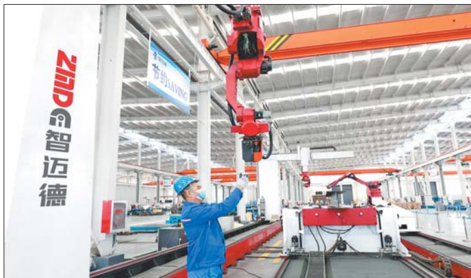
智迈德研发的装配式建筑钢梁全自动一次成型生产线拥有33项自主知识产权,打破了国外垄断。
