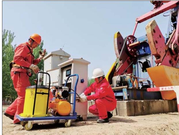
过去,游梁式抽油机保养需要停井近2个小时,而且高处的轴承保养需要员工攀爬操作,费时费力且安全风险大。为此,胜利油田技能大师、滨南采油管理三区员工李军和创新工作室成员探讨思路、画设计图,引进耐压油管,高空探头等部件,经过多次试验,一辆由高压注脂机、空压机、辅助设备等组成的移动保养车应运而生。
