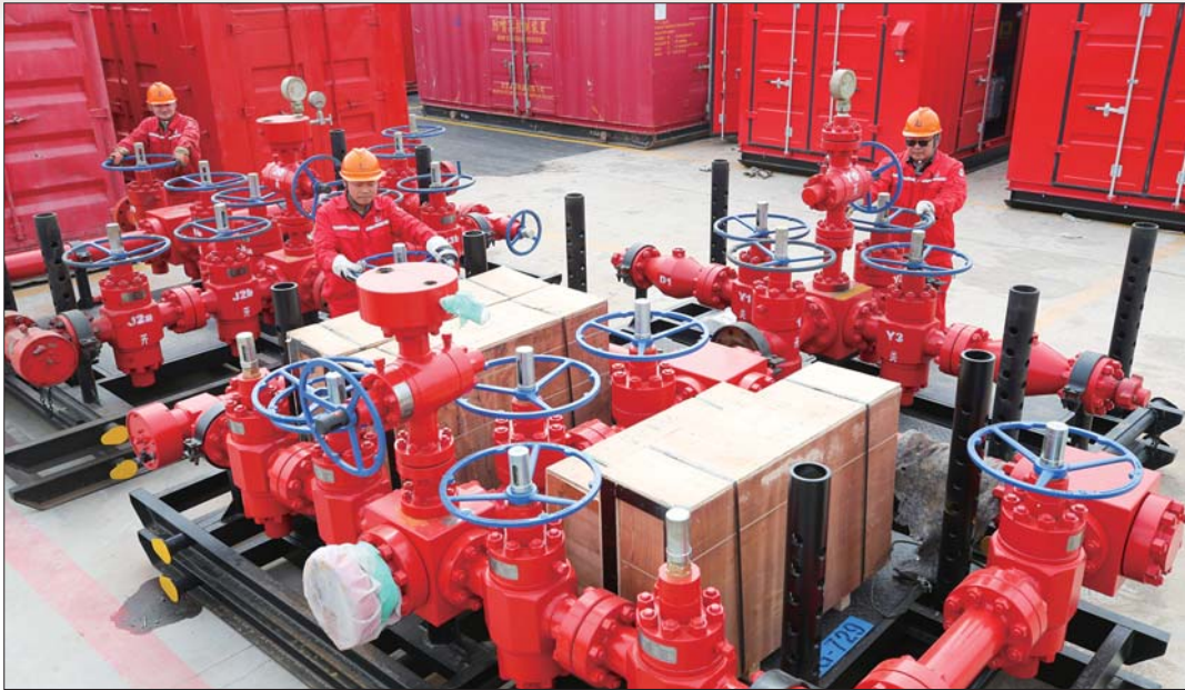
管具四队员工对与3570型防喷器配套使用的10378-70管汇的平板阀进行验收。 通讯员 杨冬玲 摄
