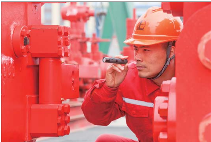
管具四队员工对防喷器铰链座进行检验。 通讯员 郑志能 摄
