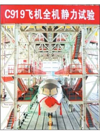
开展静力试验的C919原型机
