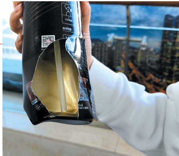
发生爆炸的灭火器瓶身底部撕裂。
