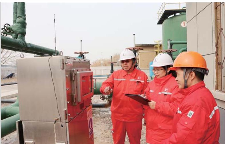
近日，胜利油田技术检测中心腐蚀与防护研究中心技术人员在现场调试水质多参数在线监测装置。据了解，这个装置由技术检测中心自主研发设计，集水中含油量、悬浮固体含量、pH值、腐蚀速率四项智能监测技术于一体，实现了油田水质四项指标动态在线监测、远程数据传输及超标即时预警，为油田采出水质量进步标准提升提供技术支撑。
