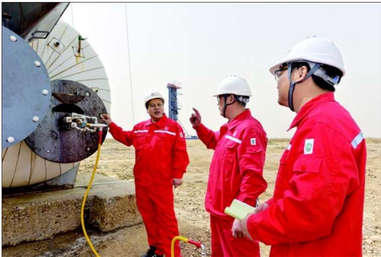
为降低高耗电加热地面工艺配套存在的问题,去年8月起,胜利油田河口采油厂组织相关技术人员,自主研发符合丛式掺水井组特点的“集中掺水燃气加热一体化撬”,取得显著的节能减费效果。
