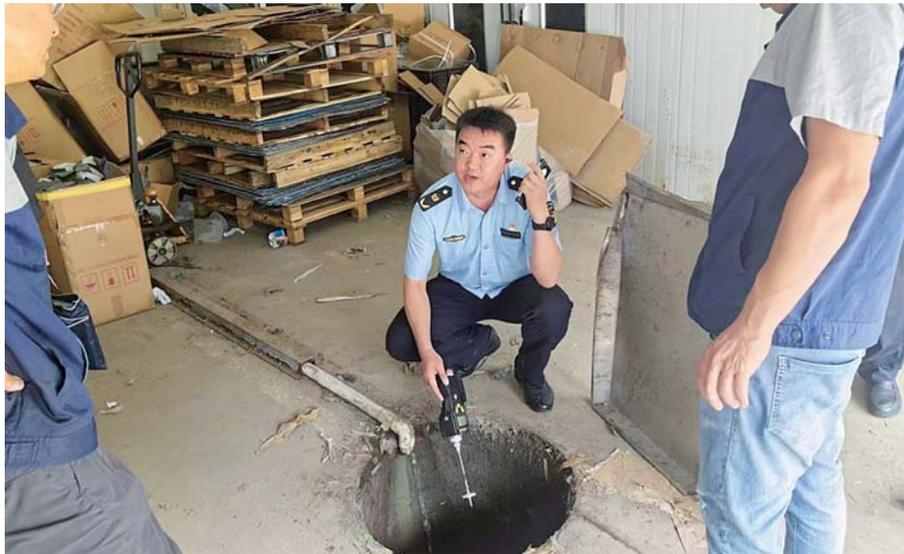
▲使用便携式VOCs检测仪器PID检测涉VOCs企业含有挥发性有机物废水的排放情况。
