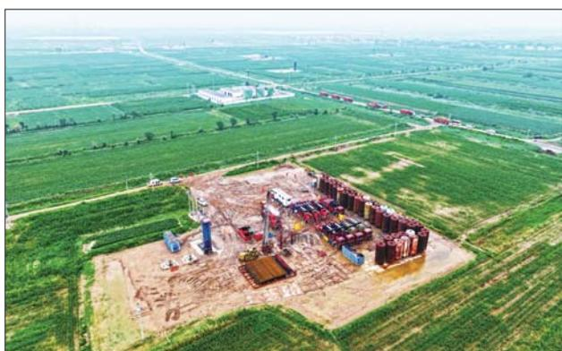
为提高新井产能,近日,胜利油田河口采油厂各方技术人员紧盯压裂施工现场优化方案,对义东11-斜12、13井组油藏实施人工造缝、加砂、改善近井地带渗透率等举措,成功压开油藏,为增储上产交出亮眼“成绩单”。
