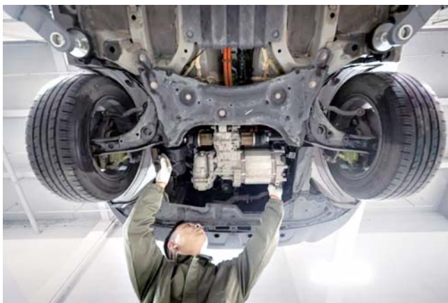
一名新能源汽车维修师在检查一辆新能源汽车的电机。新华社发
