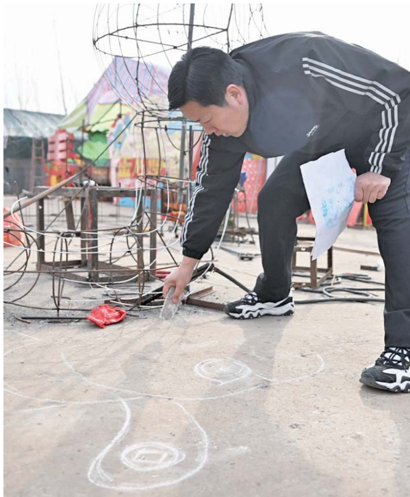
王元实将图纸上的图案画在地上,方便工人们用钢筋焊接出造型。
