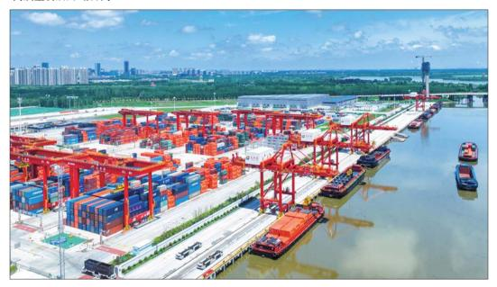
推动水运绿色低碳转型等 如果把"航"比作连接河、江 与海的通道,那么"港"就是它们 的支点。如何以港口赋能航运, 让贸易更"聪明",济宁龙拱港走 的是智慧化之路。在龙拱港堆场 内,一辆辆无人集卡正在有序运 行,凭借北斗导航、5G通信、多传 感器融合智能感知,实现车辆任 务分配,路径自动规划。龙拱港 自动化场桥和自动化岸桥全部 采用远程监管和操控,全面实现 了现场装卸无人化,无人集卡全 场高精定位2厘米以内,停车对 位时间5秒钟以内,比传统的人 工集卡对位效率提升30%以上。
