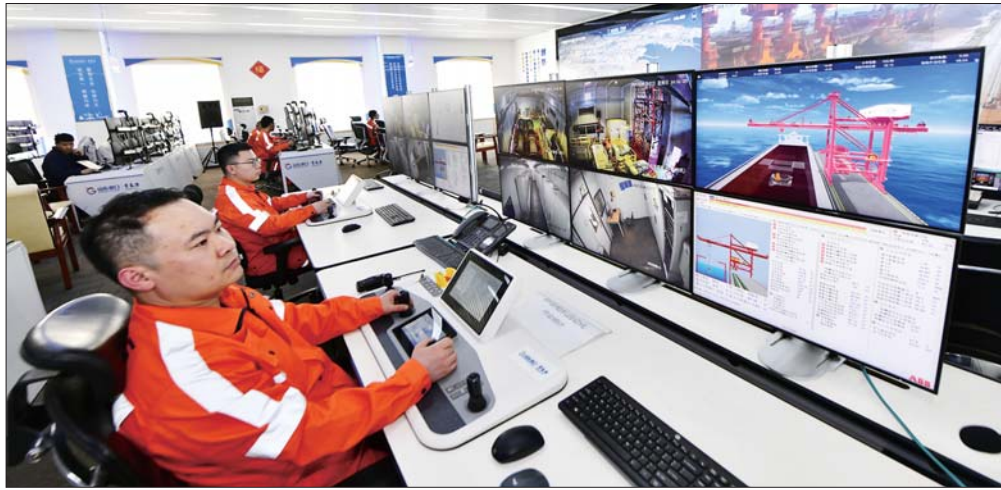
在山东港口青岛港矿石码头,远程驾驶员正在进行铁矿石装卸作业。
