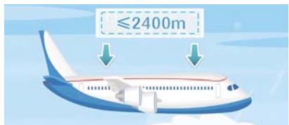
增压系统将机舱气压稳定在海拔2400米左右。
