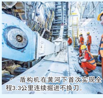
盾构机在黄河下首次实现全程3.3公里连续掘进不换刀。
