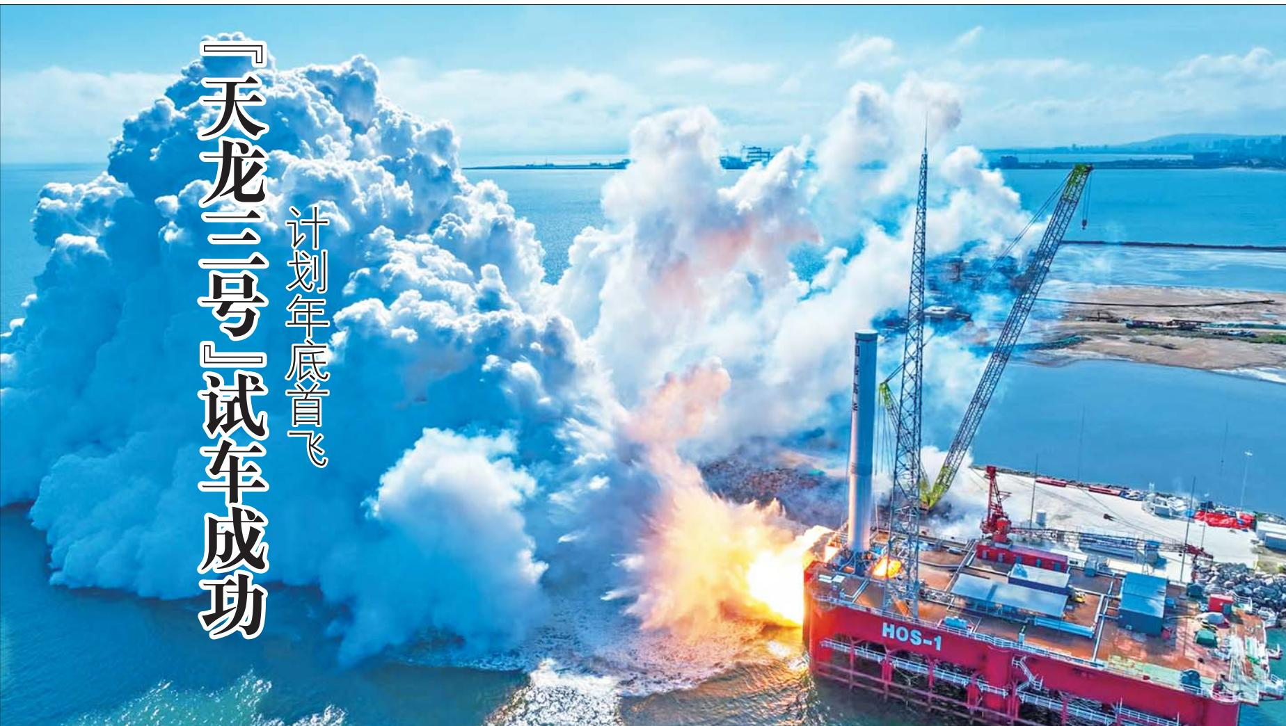
9月15日，天龙三号液体运载火箭在山东海阳东方航天港海上平台进行一级动力系统试车。此次试车验证了防风、防晃、防雷、防盐雾及发动机火焰高温防护等多项关键技术。试车过程中，各系统工作正常，满足火箭首飞的性能要求。据悉，天龙三号液体运载火箭计划于2025年底执行首飞任务。
