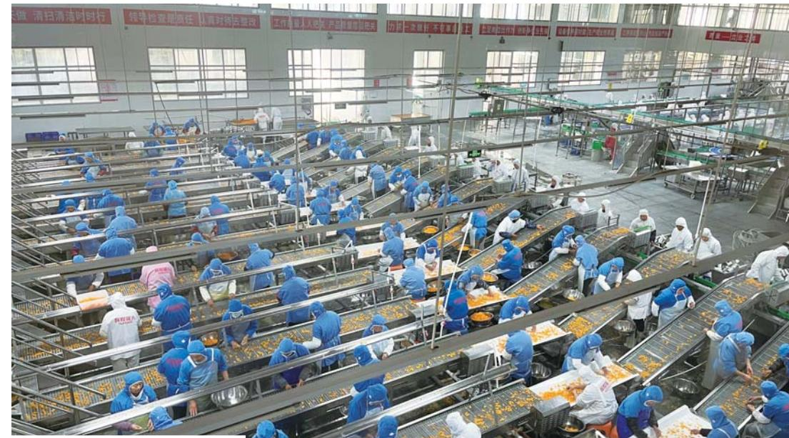
每分钟30罐的速度运转,无菌车间内工人按规范完成质检流程。党传升介绍,罐头锁住黄桃“鲜味”的秘诀,就是做到黄桃离开枝头到在罐中封口,整个过程不超过12个小时。
