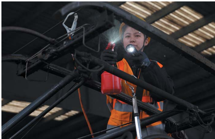
爬上车顶,检查受电弓。四五米高的作业平台,姚文凤神情专注,一丝不苟。
