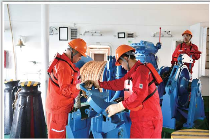
水手进行航前检查。
